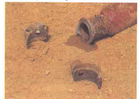
Pecah.....pump casing 'Portable Pump' dan 'male coupling' pecah semasa pertandingan kali ini
